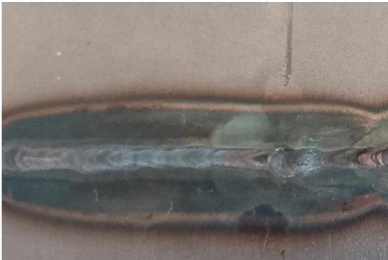
Рисунок 4.18 Зразок зварного шва з обробкою.
