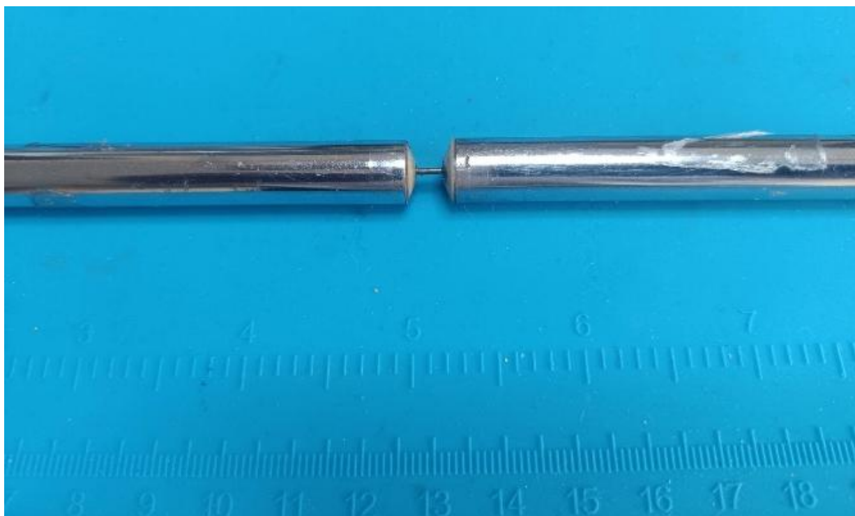
Рисунок 4.1. Розташування перетворювачів при визначенні часу затримки сигналів в ММП.
