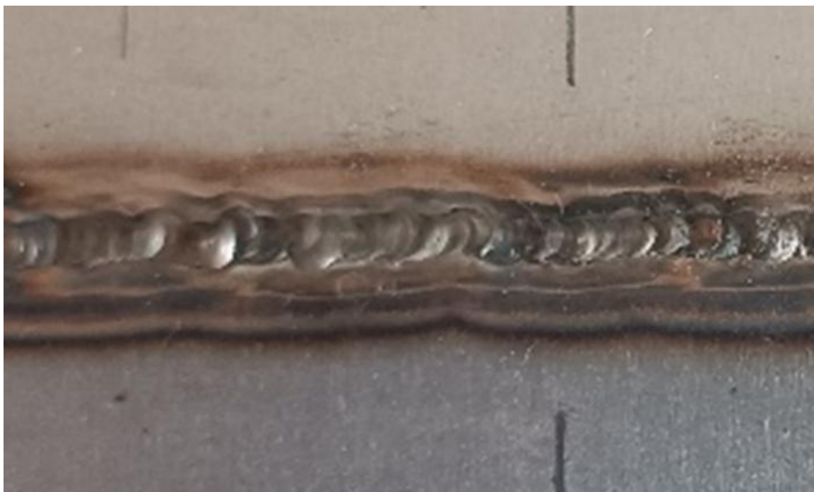
Рисунок 4.17 Зразок зварного шва без обробки
