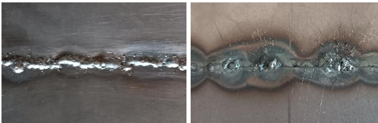
Рисунок 4.19 Зразок зварного шва з дефектом.
