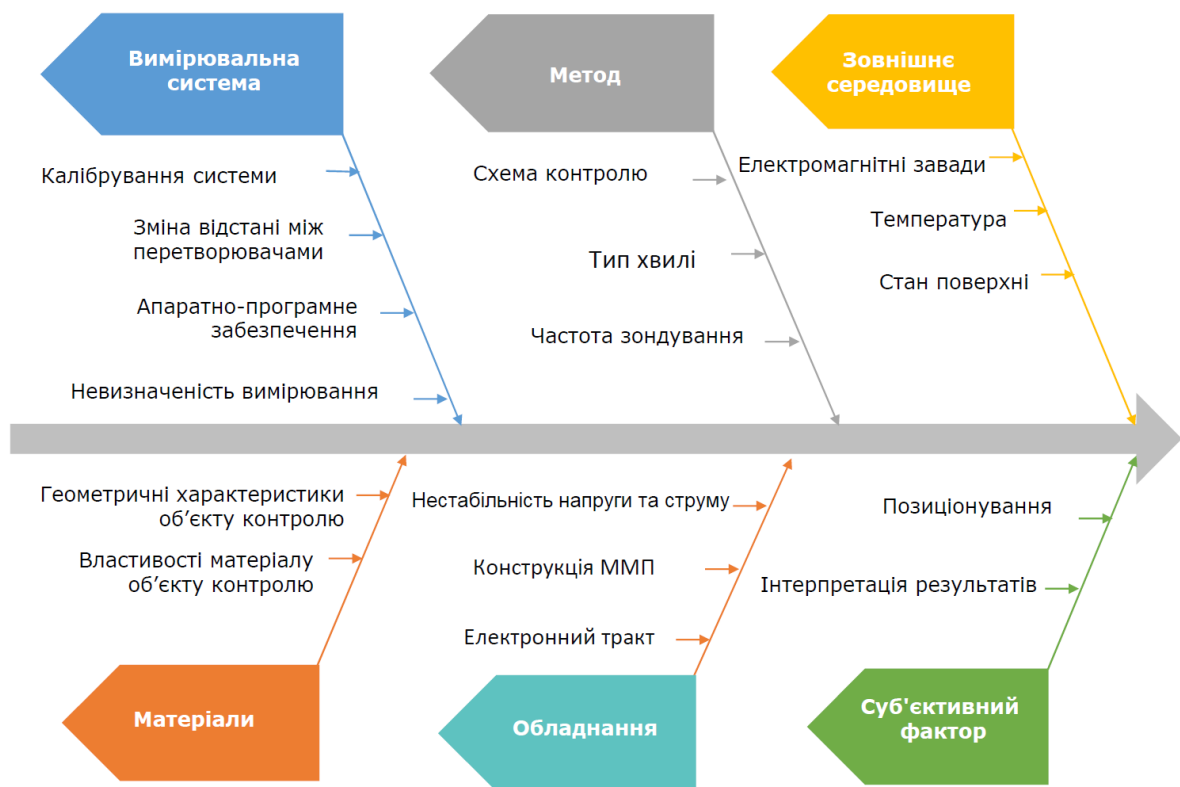
Рис. 2.1 – Діаграма факторів впливу на достовірність неруйнівного ультразвукового контролю з використанням малоапертурних магнітострикційних перетворювачів
